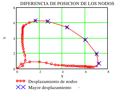
Figura 5 Diferencia en la posición de los nodos de la geometría de la figura 1 después de la optimización según la ecuación 3.
